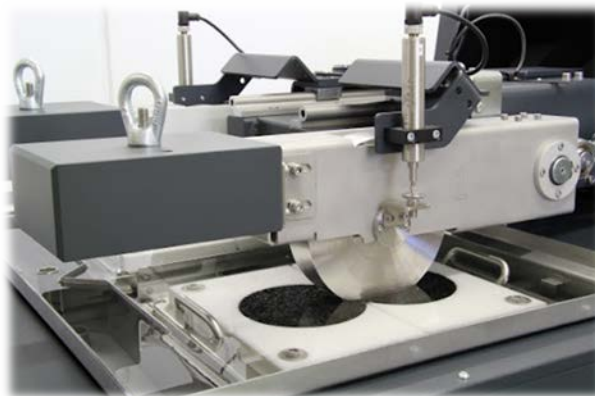
Figura 4. Esquema de dispositivo Rueda Cargada para ensayo de probetas. HWTT.
